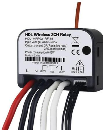
**Bezdrátové dvoukanálové relé HDL-MPR02-RF.18** obsahuje dva silové kontakty k ovládání zátěže, které jsou ovládány nezávisle. Modul má rovněž vstupy pro 4 bezpotenciálové kontakty. K nastavení modulu je třeba bezdrátová komunikační brána, např. typ HDL-MCIP-RF02.10.
