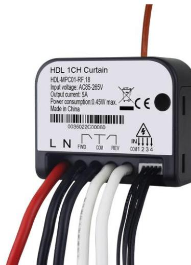
**Bezdrátový akční člen k ovládání pohonu závěsů a žaluzií HDL-MPC01-RF.18** obsahuje jeden přepínací kontakt k ovládání jednoho motoru pohonu závěsu nebo žaluzií. Modul má rovněž vstupy pro 4 bezpotenciálové kontakty.
