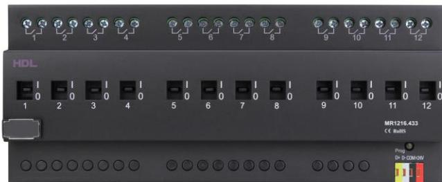
**HDL-MR1216.433 Modul inteligentního výkonového relé**, proud silových kontaktů max. 16 A, nulová spotřeba energie výkonové části, vysoká spolehlivost. Připojení na sběrnici HDL Buspro.
