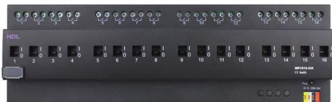
**HDL-MR1616.434 Modul inteligentního výkonového relé**, proud silových kontaktů max. 16 A, nulová spotřeba energie výkonové části, vysoká spolehlivost. Připojení na sběrnici HDL Buspro.
