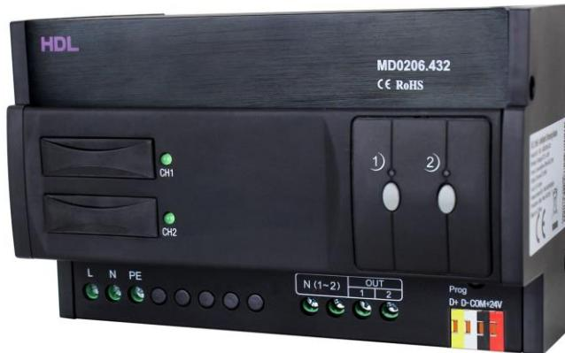
**HDL-MD0206.432 Stmívací modul** se dvěma kanály po 6 A, napájení na vstupu 240 VAC a 110 VAC. Má dva výstupní kanály, každý kanál má tlačítko pro ruční ovládání. V každém kanálu je zařazena rychlá pojistka chránící výstup proti zkratu. Indikace zkratu kanálu LED kontrolkou.
