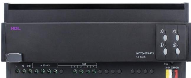
**HDL-MDT04015.433 Stmívací modul** se silovou částí založenou na technologii MOSFET. Má dva výstupní kanály po 1,5 A, pro každý kanál tlačítko k ručnímu ovládání. Volba stmívání na náběžnou nebo sestupnou hranu pro každý kanál zvlášť. To umožňuje stmívat světelné zdroje s libovolným účiníkem, činným, kapacitním i induktivním. Ochrana proti zkratu a přehřátí.
