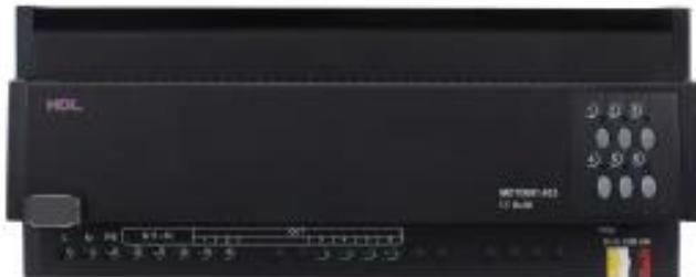
**HDL-MDT0601.433 Stmívací modul** se silovou částí založenou na technologii MOSFET. Má šest výstupních kanálů po 1 A, pro každý kanál tlačítko k ručnímu ovládání. Volba stmívání na náběžnou nebo sestupnou hranu pro každý kanál zvlášť. To umožňuje stmívat světelné zdroje s libovolným účinkem, činným, kapacitním i induktivním. Ochrana proti zkratu a přehřátí.
