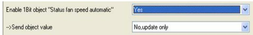
Fig. 31: 1Bit fan speed automatic status
