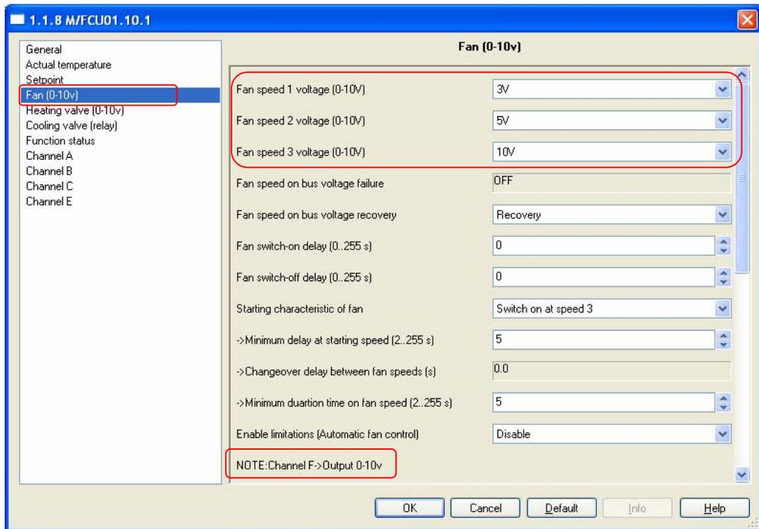
Fig.13: “Fan(0-10v)” parameter window
