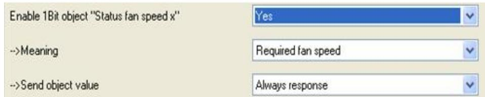
Fig. 28: 1Bit fan speed status
