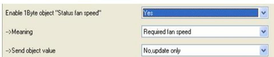
Fig. 29: 1 byte fan speed status
