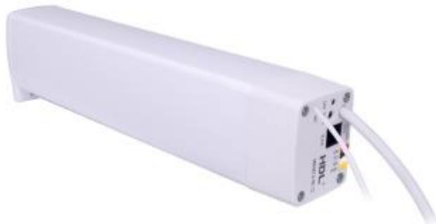
**HDL-MWM70-RF.12 motor pohonu závěsů s řídícím bezdrátovým modulem** s integrovaným kontrolérem pro bezdrátovou komunikaci se sítí HDL Buspro Wireless. Podpora ručního režimu, ochrana proti přetížení a tepelná ochrana. Modul má rovněž vstupy pro 3 bezpotenciálové kontakty využitelné k ovládání závěsů 3 tlačítka.
