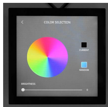
Obr.5 Osvětlení: stránka k nastavení barvy světla, přístup z poslední položky viz obr. 4.
