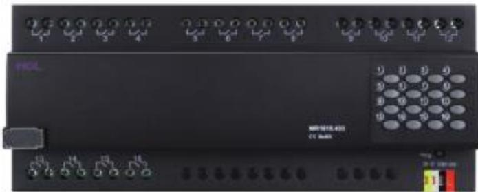
**HDL-MR1610.433 Modul inteligentního výkonového relé**, proud silových kontaktů max. 10 A, nulová spotřeba energie výkonové části, vysoká spolehlivost. Připojení na sběrnici HDL Buspro.
