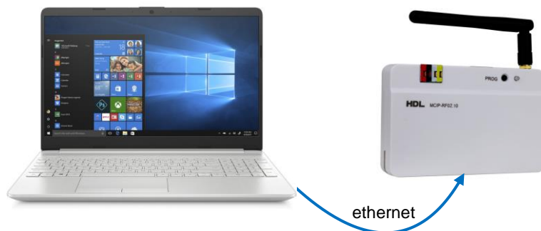
Obr.1 Bezdrátová brána HDL-MCIP-RF02.10 a její připojení k PC
