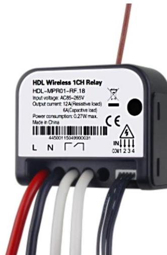
Bezdrátové jednokanálové relé **HDL-MPR01-RF.18** obsahuje jeden silový kontakt k ovládání zátěže. Modul má rovněž vstupy pro 4 bezpotenciálové kontakty. K nastavení modulu je třeba bezdrátová komunikační brána, např. typ HDL-MCIP-RF02.10.
