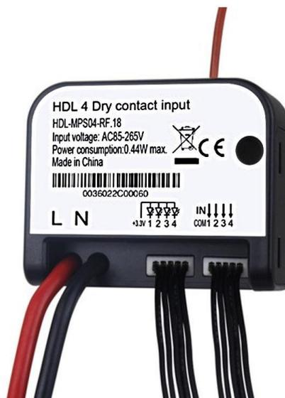
**Bezdrátový akční člen HDL-MPS04-RF.18** má vstupy pro 4 bezpotenciálové kontakty, na které lze připojit např. kontakty klasického vypínače, umístěného ve stejné instalační krabici nebo kontakty dveřního spínače atd. Modul má rovněž výstupy k napájení čtyř LED kontrolkek. K nastavení modulu je třeba bezdrátová komunikační brána, např. typ HDL-MCIP-RF02.10.
