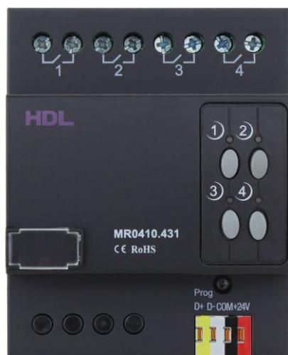
**HDL-MR0410.431 Modul inteligentního výkonového relé**, proud silových kontaktů max. 10 A, nulová spotřeba energie výkonové části, vysoká spolehlivost. Připojení na sběrnici HDL Buspro.
